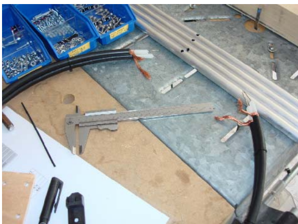
Detalle del coaxial empleado y los tubos centrales con el taladro central
