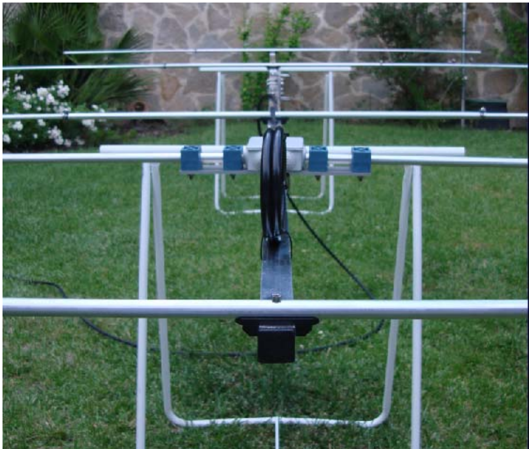
Vista de la placa de unión del boom al mástil
