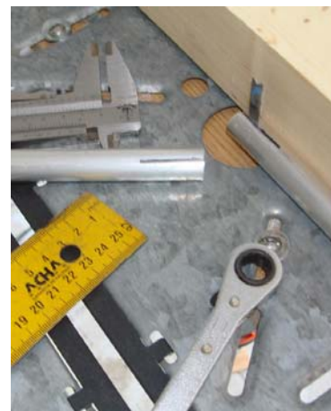
Corte longitudinal de los tubos centrales
