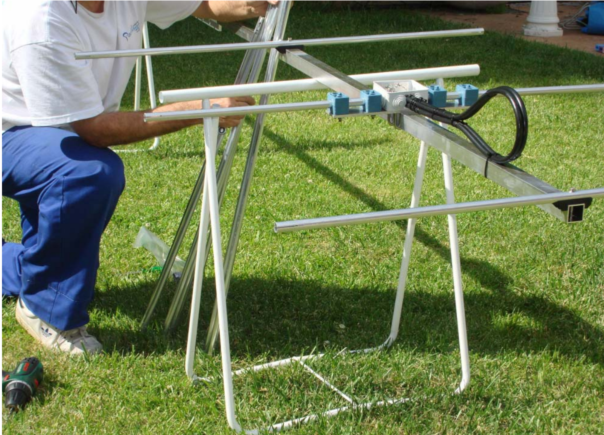
Foto en la que se aprecian los tubos (16mm) centrales del reflector, excitado y director 1, y a falta de ensamblar el tubo de 12mm.
