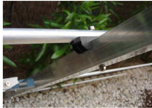
Ejemplo de sujeción elemento al boom
