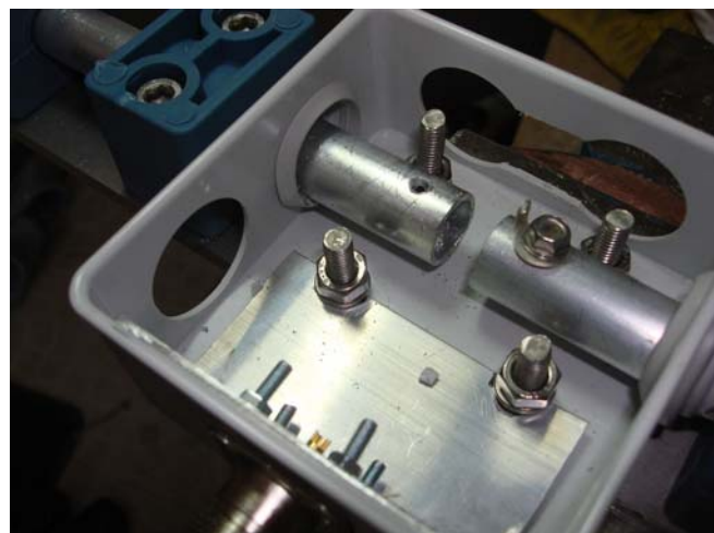
Caja lista para el montaje del coaxial adaptador de impedancia
